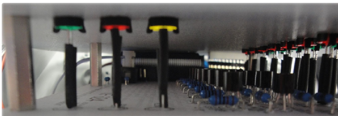
obr. 1: Simulátor MF 624 – osazený plošný spoj
